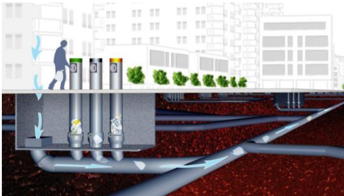
Figur 4-1 Stasjonært avfallssug (kjelde: www.envac.no )
