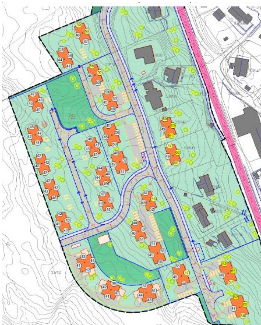
Figur 32 Høgaste ekvivalente støynivå ved fasade, Lden DB.
