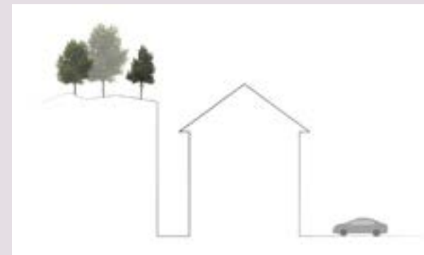
Figur 25: Døme på uheldig høg skjering, som kan føra til steinsprang og dårlige lysforhold inne og ute.
