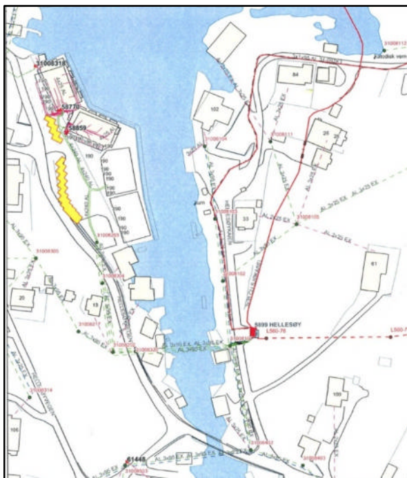
Kablar i grunnen, samt nettstasjon nr.5899 vist i raudt. (Kjelde: BKK).
