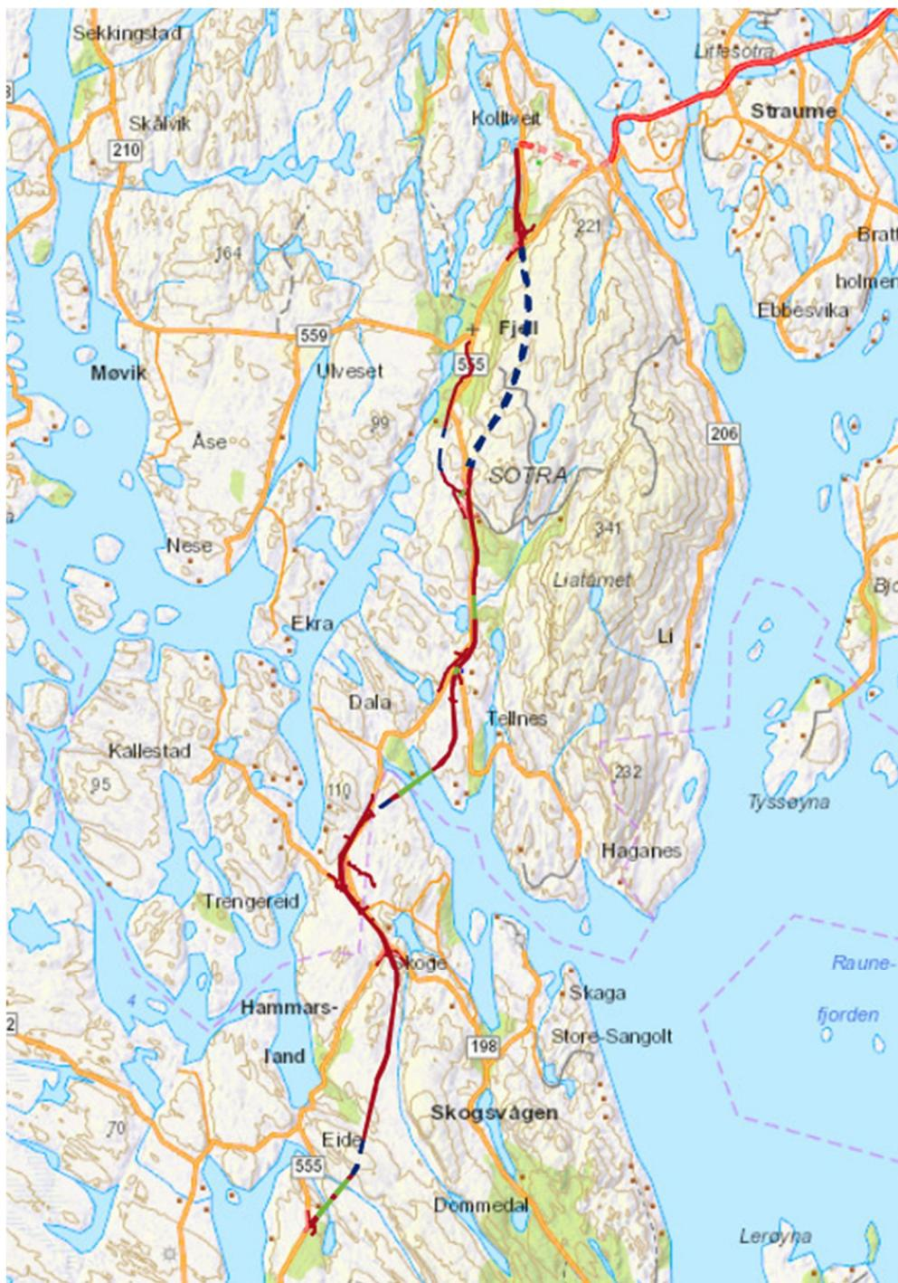
Figur 7-1 Kartutsnitt som viser planlagt vegtrasé for ny fv 555. Brei raud strek er veg i dagen, blå stipla strek er tunnel og grøn strek er bruer. Tynnare strek er lokalvegar som blir regulert som ein del av planen.
