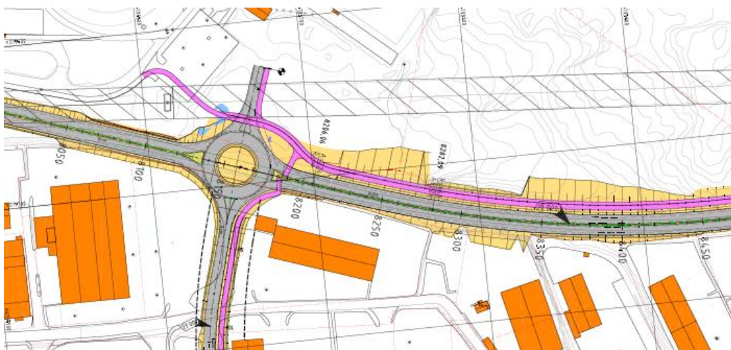
Figur 8-22 Vegteikning av kryss på Ågotnes nord, rundkøyring med 4 armar. Kjelde: Multiconsult
